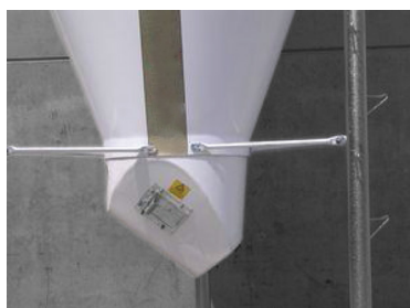
Разгрузочная горловина для шнекового транспортера, угол от 20° до 60°
