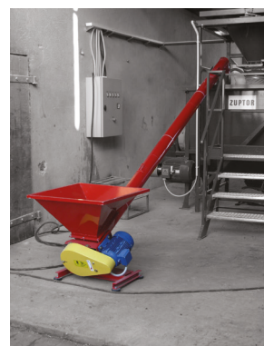
Шнековый питатель с корзиной для загрузки добавок в смеситель с уровня пола
