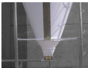
Разгрузочная горловина с присоединенным элементом для гибкого шнека
