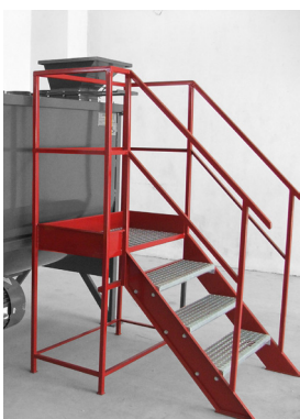
Lépcsők a szerelőplatformhoz
