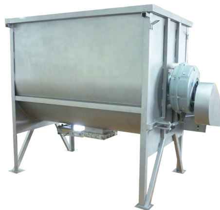
▲ MIESZALNIK POZIOMY 500 KG ZE STALI NIERDZEWNEJ
