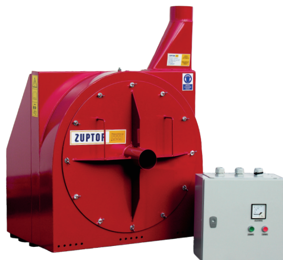
▲ ROZDRABNIACZ BIJAKOWY SSĄCO-TŁOCZĄCY 37 KW
